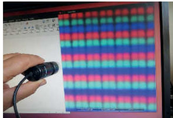
Abb. 5: Das auf der weißen Fläche aufgesetzte Mikroskop (links) bringt das rechts zu sehende Bild der vergrößerten Linien in den drei Grundfarben.
