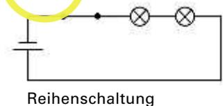
Wird ein Verbraucher aus dem Stromkreis entfernt, wird der Stromfluss unterbrochen und die restlichen Verbraucher arbeiten ebenfalls nicht mehr. Stromverbraucher in diesen Schaltungen können also nicht unabhängig voneinander betrieben werden.
