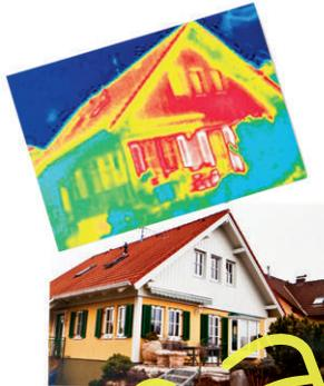
Nicht nur die Sonne sendet Wärme aus, auch heiße oder warme Körper senden Wärmestrahlung aus. Also auch ein Mensch oder eine warme Herdplatte. Wir Menschen können die Infrarotstrahlung als Wärme spüren, aber nicht sehen... Mit einer Wärmebildkamera kann man ein Bild aufnehmen, auf dem man Wärme erkennt. Zum Beispiel, wie viel Wärme ein Haus ausstrahlt. Je intensiver rot ein Bereich ist, desto mehr Wärme wird ausgestrahlt. Blaue und grüne Bereiche sind viel kälter.
