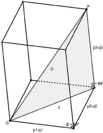
Gegeben sind die Punkte  $P(p_1 | p_2 | p_3)$  und  $Q(q_1 | q_2 | q_3)$ . Der Abstand der Punkte  $P$  und  $Q$  kann aufgefasst werden als die Länge der Raumiagonalen eines Quaders. Die Kanten des Quaders haben die Länge  $|p_1 - q_1|$ ,  $|p_2 - q_2|$  und  $|p_3 - q_3|$ .
