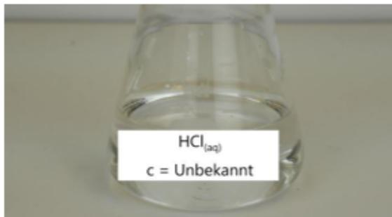
1. In einem Erlenmeyerkolben wird 10 ml konzentrierte Salzsäure mit 90 ml destilliertem Wasser verdünnt. Die Konzentration der Salzsäurelösung ist nicht bekannt. Die Salzsäurelösung wird in ein Becherglas gefüllt.
