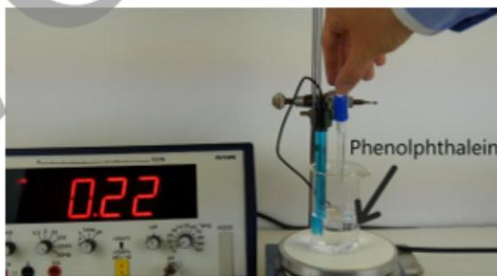
5. In die Salzsäurelösung wird der Indikator Phenolphthalein gegeben.
