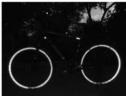
Abb. 2: Seitliche Blitzaufnahme eines Fahrrades, dessen Felgen mit Retro-Reflektorfolien beklebt sind
